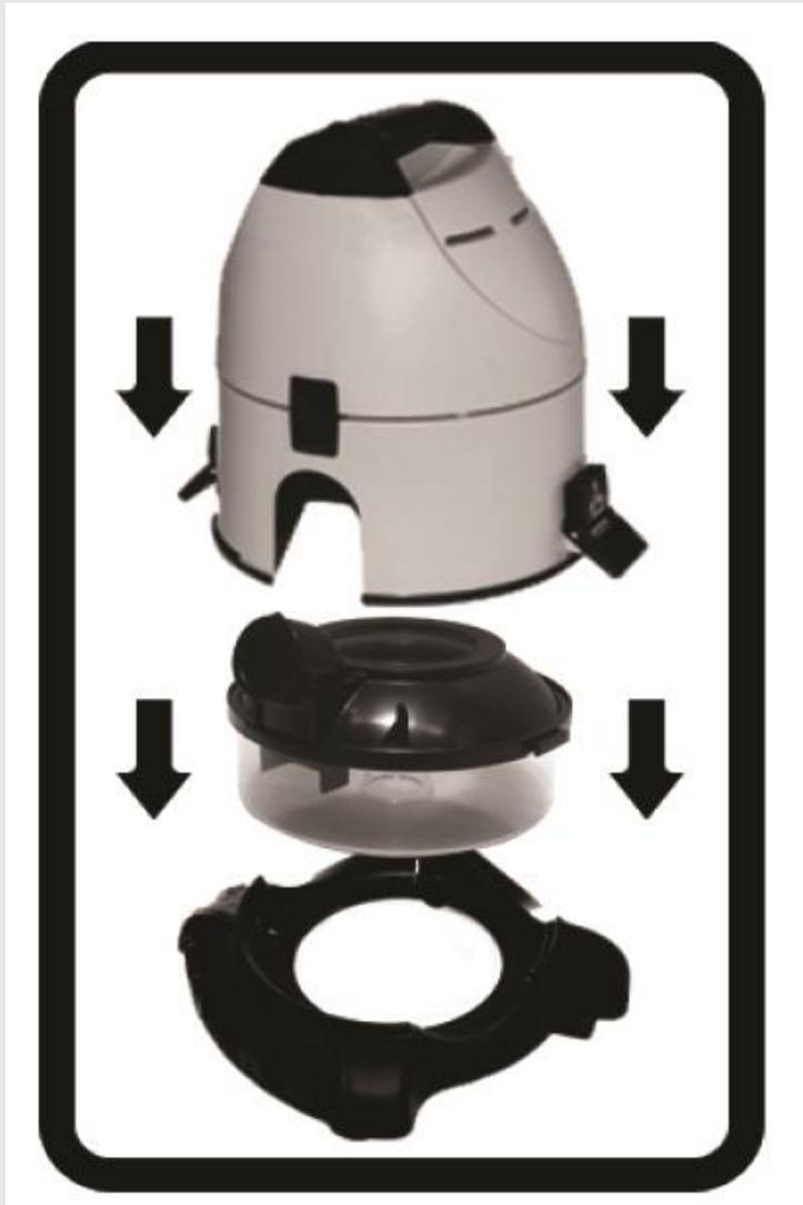
La unidad motora se coloca sobre el recipiente de agua de modo que la toma de aspiración sobresalga por la abertura lateral. El borde de la unidad motora debe descansar firmemente sobre la ranura superior del recipiente, de lo contrario la máquina no funcionará. Coloque y asegure los dos sujetadores laterales sobre el borde del recipiente. Ponga el aparato sobre el soporte rodante.
