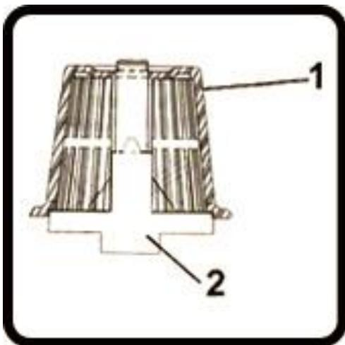
La turbina (1) debe descansar plana en la base (2) esto se logra girando la turbina hasta que caiga en su lugar.
